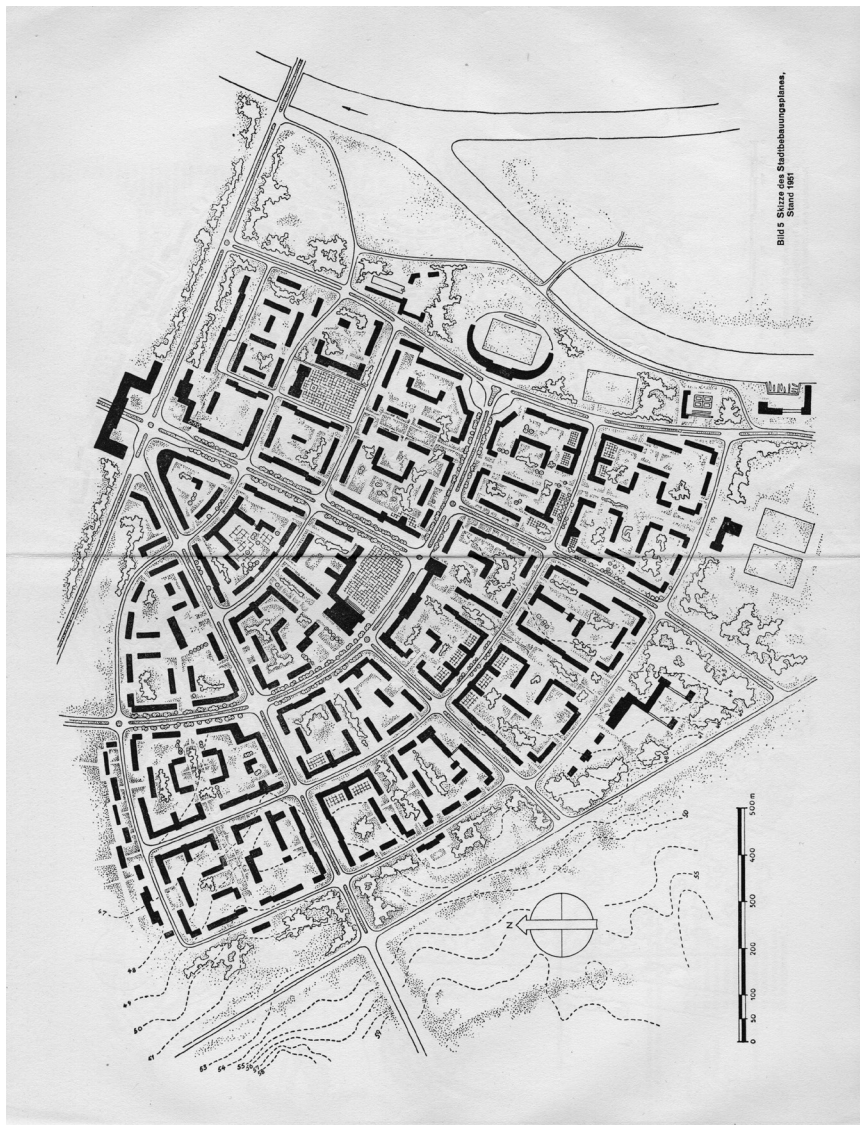
Abb. 5: Der von Kurt Walter Leucht erstellte Aufbauplan für Stalinstadt/Eisenhüttenstadt aus dem Jahr 1951. Links oben ist das geplante monumentale Eingangstor zu sehen, das einerseits zur zentralen Achse der Stadt hinführt und andererseits den Ein- und Ausgang des Eisenhüttenwerks bildet (das Hüttenwerk selbst ist nicht mehr auf dem Plan abgebildet). Der Plan wurde zwar nicht in genau dieser Form in die Realität umgesetzt, aber er zeigt an, dass die Neugründung der Stadt von der Eisenhütte ausgeht und auch von hier aus konzipiert wird. Entnommen aus Kurt W. Leucht: Die erste neue Stadt in der DDR. Planungsgrundlagen und -ergebnisse von Stalinstadt, Berlin 1957 , Bild 5.
